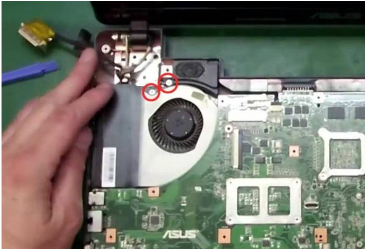
5. Replacez les vis repérées par une flèche blanche, reprises dans le compartiment 7
