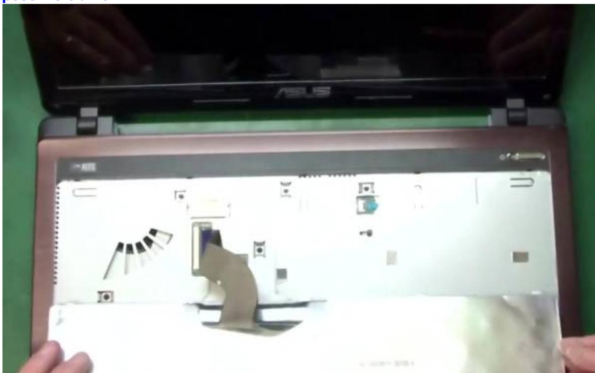
**Reclipsez les encoches autour du clavier en enclenchant les ergots**
