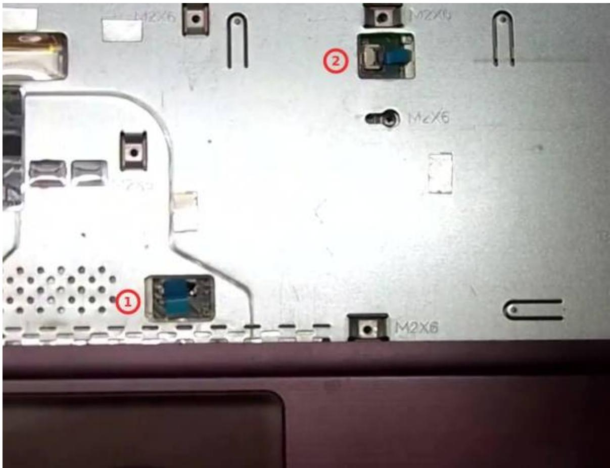
**5. Replacez les vis sous le clavier, reprises dans le compartiment 5**
