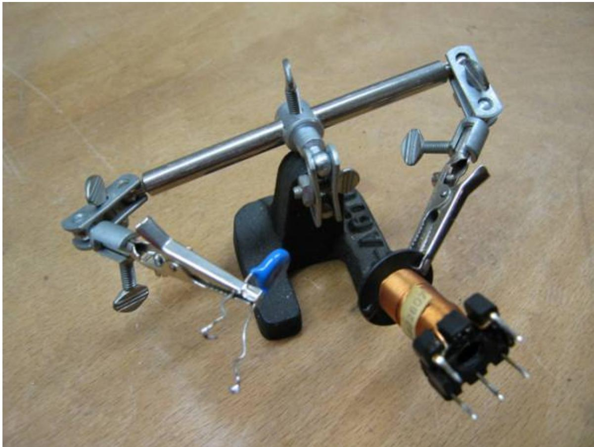
C'est un support monté de deux pinces crocodiles et disposant d'un pied en fonte.
