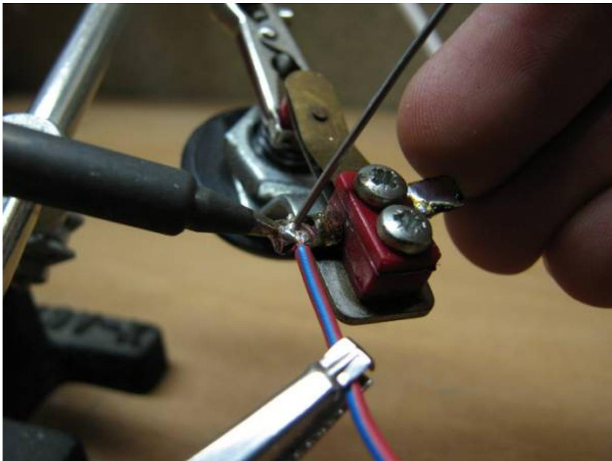
Je commence à déposer un peu de soudure sur la lamelle du bouton et rapidement je viens en mettre sur le fil que je veux souder. En baladant le fil à souder, je répartis la soudure partout. Ca permet aussi d'apporter du flux décapant partout. Sur la photo, il y a un peu trop de soudure toujours à cause de l'appareil photo qui me fait poireauter trop longtemps pour prendre la photo.
