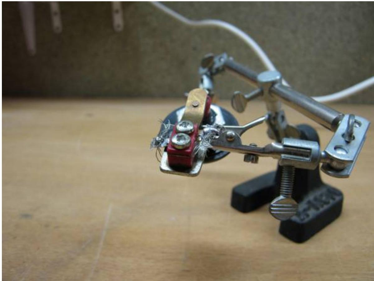
Avec une panne nettoyée et très légèrement chargée en soudure, je viens mettre en contact la panne et la grosse goutte de soudure déjà présente sur le bouton.
