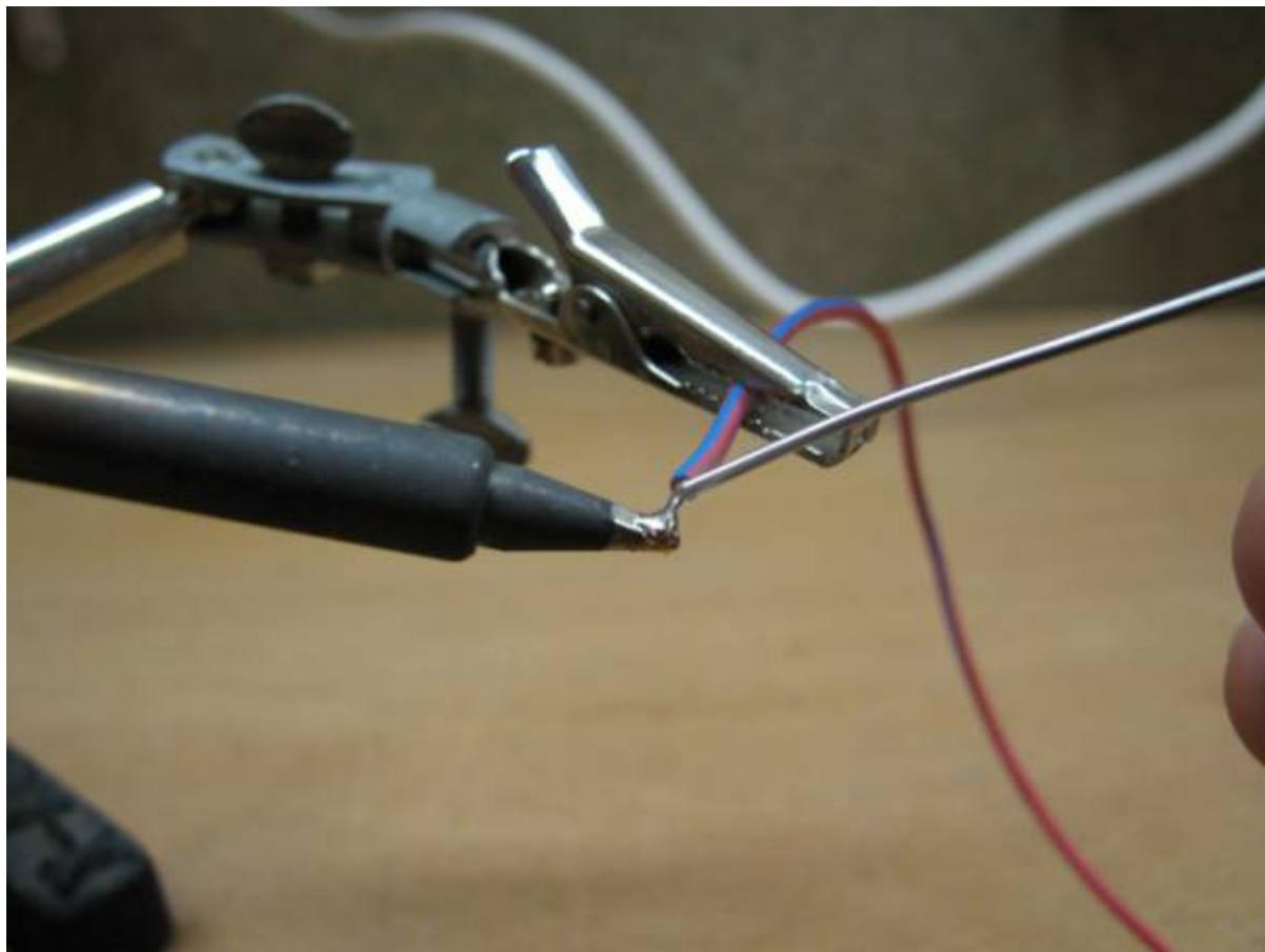
Mise en place des éléments à souder avec la troisième main :
