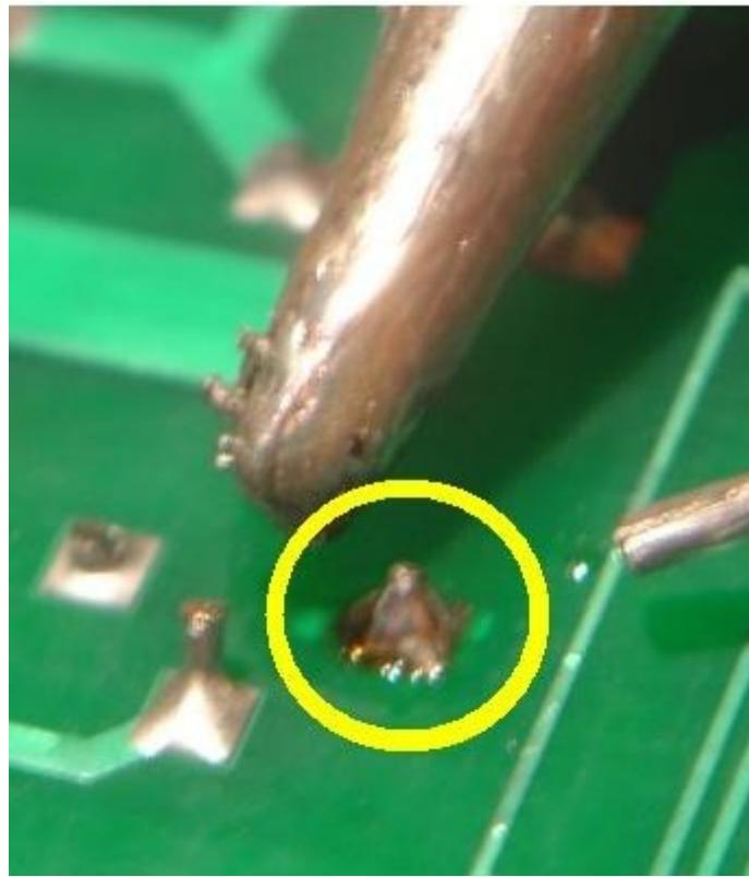
Pour les composants à plusieurs pattes (circuits intégrés ...), déposer la soudure étain-plomb sur toute une ligne de pattes (les 4 d'un boîtier DIP8 par exemple) puis faire des allers retours sur la ligne.
